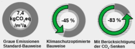
Durch klimaschützendes Bauen – im Beispiel Holzrahmenbau - lassen sich die grauen Emissionen um 45 % vermindern. Wird berücksichtigt, dass im verbauten Holz CO<sub>2</sub> eingelagert wird, dann liegt die Minderung sogar bei 83 %. Der Rohstoffverbrauch lässt sich um 50 % mindern.
